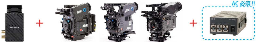
AC 駆動中のカメラ本体の DC 出力 (LEMO2pin, RS3pin 等) から BOLT6 に給電すれば「AC 電源から供給」と見なされます (カメラ背面の V マウントバッテリーの D-Tap ではなく)
