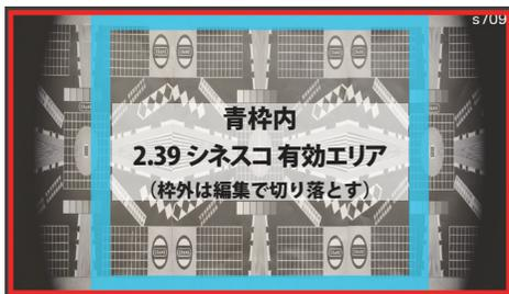
収録エリアのセンサーサイズ: 35.9 x 20.2mm
