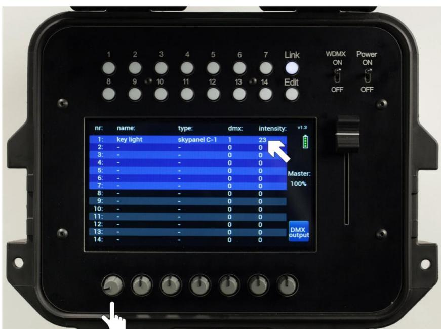
ホームページでは対応している画面下のダイヤルを使用してフィクスチャーの光量の操作ができます
