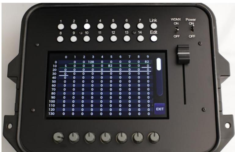
この状態でアドレス19を選択すると赤い線が消えてアドレス19から、Skypanel がモード1の状態、12チャンネルの上に白い線が引かれます
